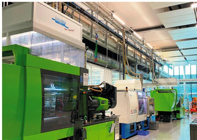
*Die Produktion wurde um drei neue Spritzgussmaschinen erweitert. Die Kunststoffteile werden mit Hilfe von Laminaufbauten vor Kontamination geschützt. (Bild: Hamilton)*
