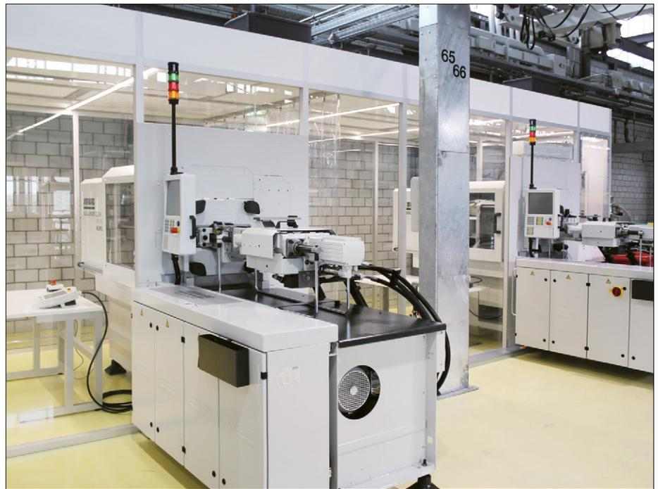
Die Spritzgiessereinheiten mit den hohen Wärmelasten bleiben ausserhalb des vollverglasten Reinraums.
